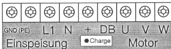
Verwenden Sie für die Verbindung zwischen Frequenzumrichter und Motor ein geschirmtes Kabel. Legen Sie die Abschirmung des Kabels an beiden Enden so kurz wie möglich auf Erdpotential. Vermeiden Sie Kabellängen über 30 Meter.
