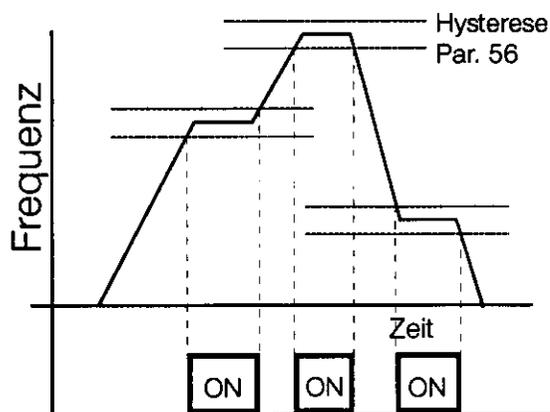
In einer weiteren Funktion mit dem Parameterwert "1", wird der Ausgang RUN verwendet, um anzuzeigen, daß die Sollfrequenz innerhalb eines definierbaren Toleranzbandes ist.
